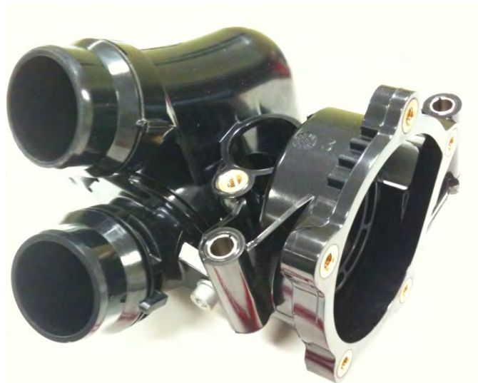
冷却系统模组（节温器+冷却水泵） PPS+GF/MD65%
