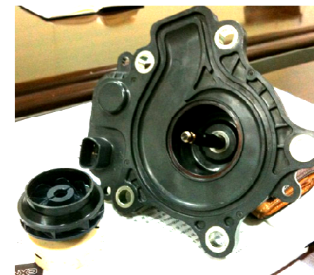
电动冷却水泵 PPS+I+GF30% PPS+GF40%
