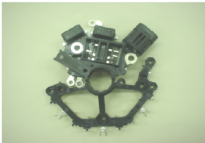
交流发电机 整流器 PPS+GF/MD70%
