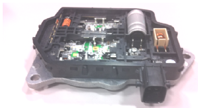
电子控制装置盒子 PPS+GF/MD50% Alloy
